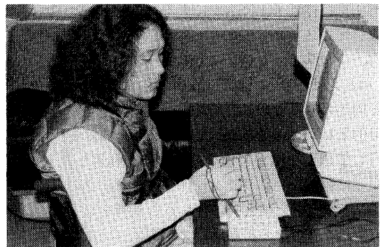
図2 キー操作によるマウスエミュレータ Fig.2 Mouse-emulator by step-keys.
