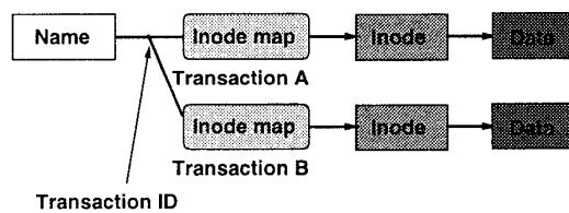
Inode map は stable な状態ではディスク上に存在するものであるが、通常はキャッシュして参照される。複数の inode map を同時にキャッシュしておいて何らかの外部の要求に従って使用するものを切り換えるようすれば、変更はどの inode map へのポインタを参照するかを変えるだけで済む。よって、この多重化にともなうオーバーヘッドはさほど大きないと考えられる。
