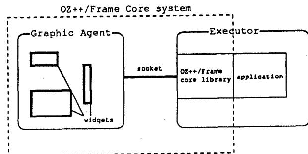
OZ++ は既存 OS 上で専用カーネルを実行しその上でオブジェクトを動作させるミドルウェアの手法を探用している。このカーネルをエグゼキュータと呼ぶ。エグゼキュータの実装の都合上 X-lib を直接リンクできない。このため実際に描画を行ないイベントをハンドリングする部分はエグゼキュータ上ではなく別プロセスで実装される。このプロセスをグラフィックエージェントと名付けた。
