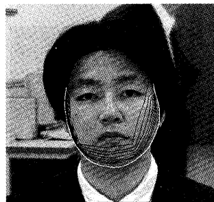
図 17 顔に対する動的輪郭モデルの反復初期化. 黒い線は, 動的輪郭モデル初期位置の更新されていく様子を示しており, 白い線は最終的な収束位置を示す
