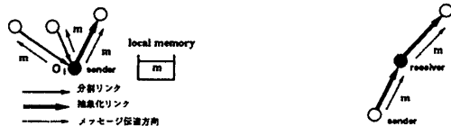
(c) 分割リンク、抽象化リンクの逆向きでメッセージを受信した場合 (d) (c)でさらに、 m_1 と m_5 を結合し m_6 が生成可能な場合
