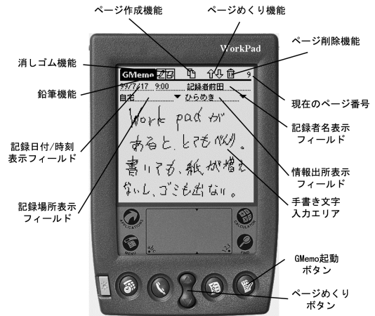
図 2 WorkPad の全体図と GMemo の画面例
