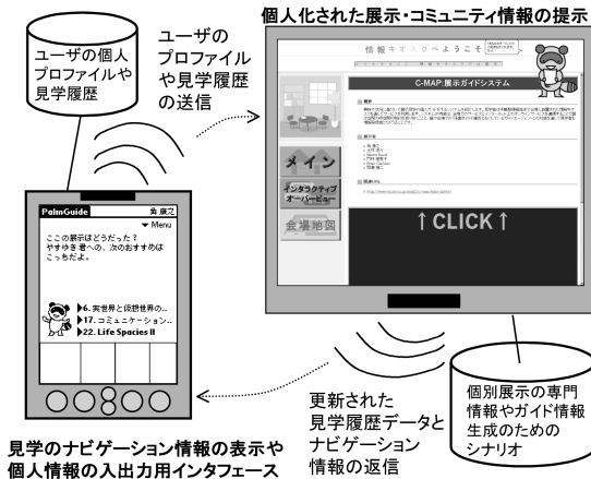
図2 PalmGuideと展示ディスプレイの連携による個人化情報提示
