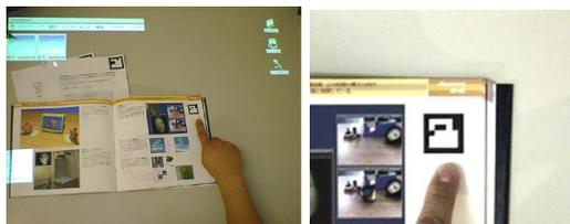
図5 利用者のポインティングジェスチャ(左)とパンチルトカメラによる指先周辺の拡大表示(右)
