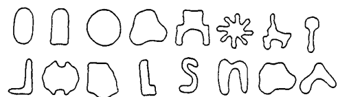
図2. 離散逆フーリエ変換による低周波成分からの再生結果
