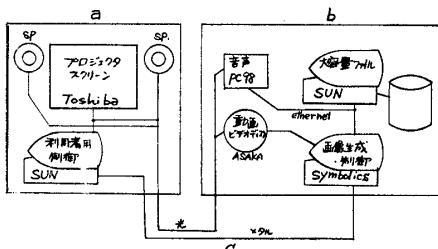
利用者端末は端末の制御を行い、図書内容の表示を行うUNIXマシン、センタからの検索用のビデオ信号と先のUNIXマシンの図書内容のビデオ信号とが表示できるビデオ・ディスプレイ、センタからの検索補助用ステレオ音声を出力する音響装置とから構成される。
