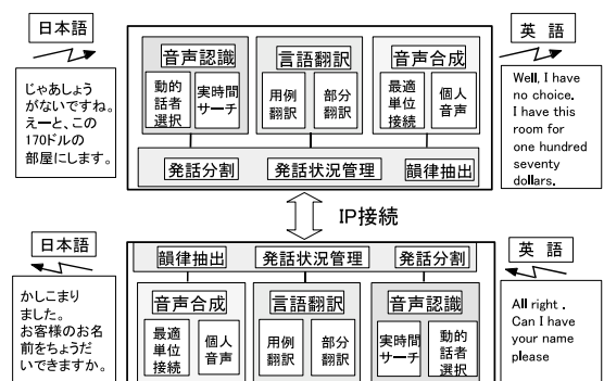
図1 音声翻訳システム(ATR-MATRIX)の構成 Fig. 1 Configuration of ATR-MATRIX speech translation system.
