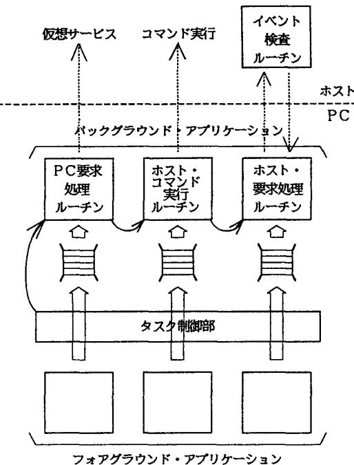
図1 MML処理の遅延実行の機構
