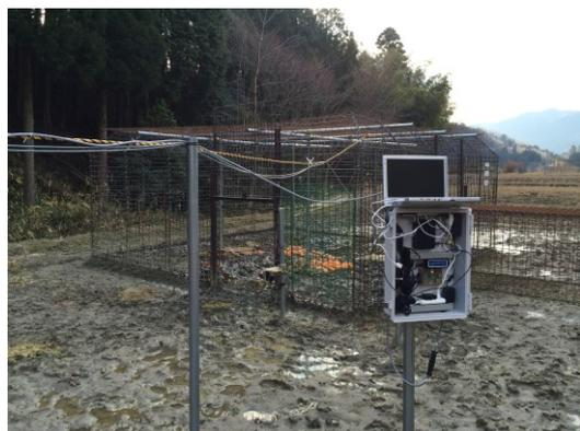
図 14 罾と監視システム (PC・Kinect は箱に格納)
