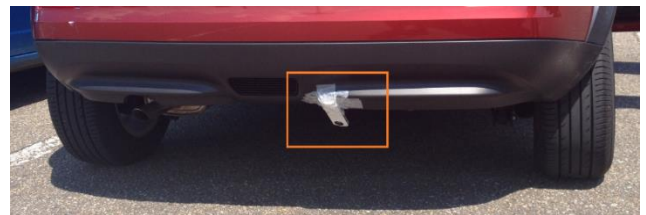
図1.車両の後面底部に取り付けたカメラ
