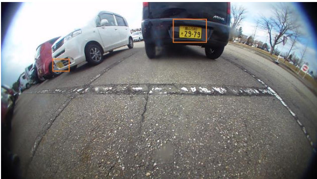
図3 後面底部に取り付けた半球カメラで撮影された画像
