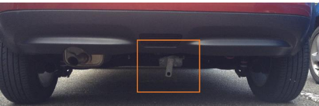
図4.下腹部に取り付けた天球カメラ
