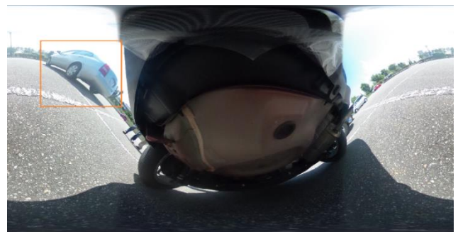
図2 後面底部に取り付けた天球カメラで撮影された画像
