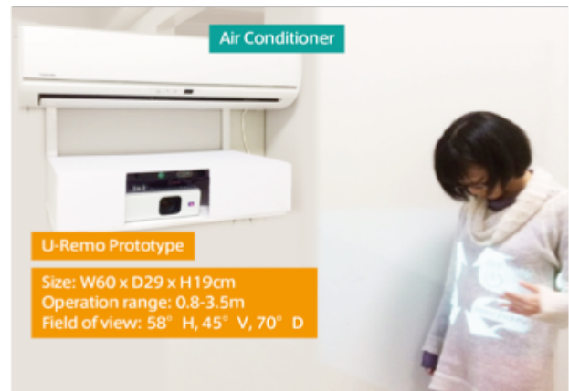
図1 U-Remo : ユーザの身体を検出し、胴体部にジェスチャの手がかりとなるアニメーションや画像を表示させ、ジェスチャ操作を支援する
