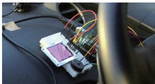
図 1 既製品のマイコン／センサを車内に設置した事例。固定が難しく、外観も損ねる。
