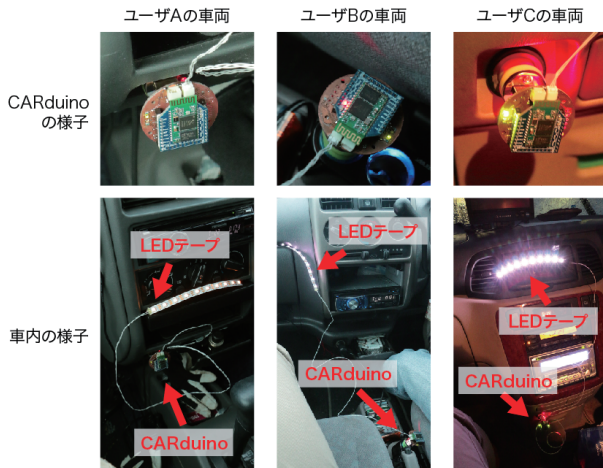
図 13 CARduino を各車両に取り付けた様子
