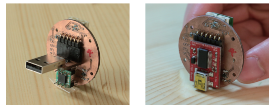
図6 給電用基板を装着した様子とプログラムを書き込む様子。
