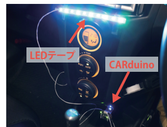
図 9 LED テープを車内に設置した際の例
