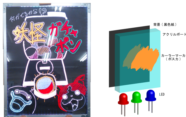
図 2 LED サインボードの外観と機構図
