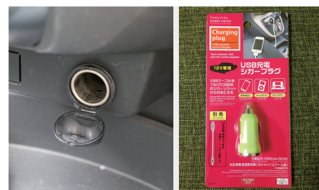
図 3 車内にあるシガーソケットの例とシガーソケットに差し込む USB 給電機. ダイソーで 100 円で購入した.
