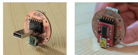
図 6 給電用基板を装着した様子とプログラムを書き込む際の様子。
