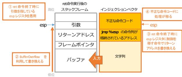
図 4 Return-to-Register 攻撃時のスタックメモリイメージ
