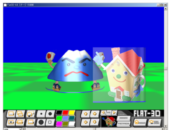
図 1 Flat3D システム：システムの画面は共有仮想空間に対して描画を行う部分と GUI 部分に大別される
