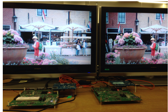
図 10 H.264/AVC 実機検証の試験環境
