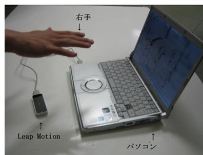
図6 パソコンと接続した Leap motion
