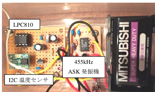
図 13 搬送波 455kHz の送信機 Figure13 455kHz transmitter
