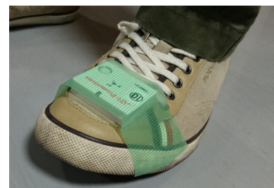
図 5 靴に搭載されたセンサ
