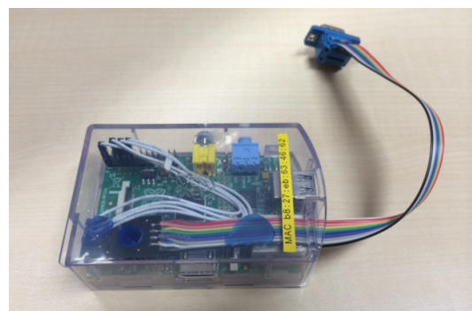
図 3 Raspberry Pi を利用したサイネージ表示デバイス Figure 3 Signage Viewer Device using Raspberry Pi.
