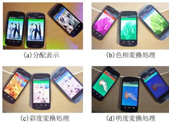
(a)分配表示 (b)色相変換処理 (c)彩度変換処理 (d)明度変換処理
