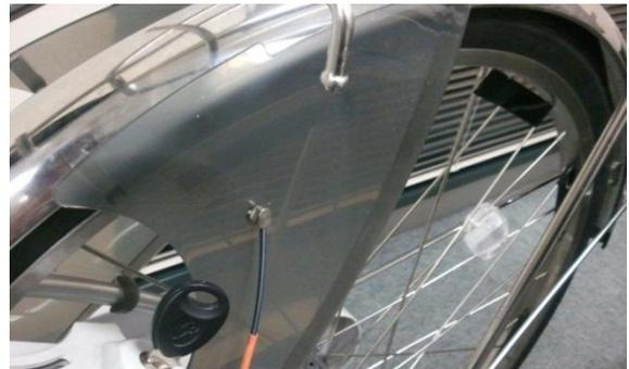
図2. 光電センサを装着した自転車
