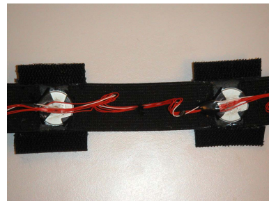
図6 Active Belt ver.2内部の配線 Fig. 6 Wiring inside of Active Belt ver.2.
