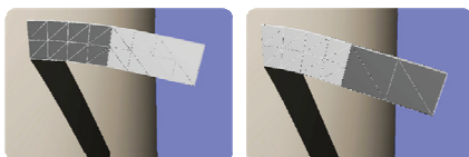
図4 濃い部分が薄い部分に比べて硬い場合のシミュレーション結果
