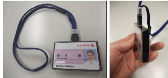
図 2 VoiStrap 端末の概観
