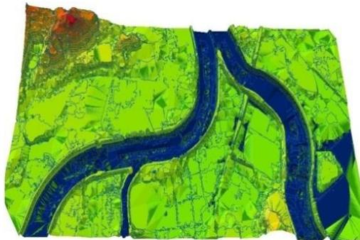
図3 遠賀川の浸水シミュレーション
