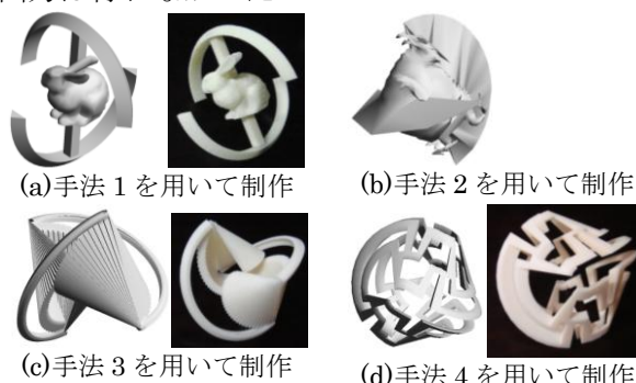
図 6 提案システムでデザインした 3D モデルと, 3D プリンタによる出力結果
