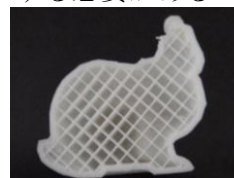
図 7 3D プリンタによる出力物体の内部の様子
