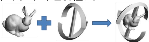
図 3 入力メッシュ形状 (左), スフェリコン骨格構造 (中央), 出力形状 (右)
