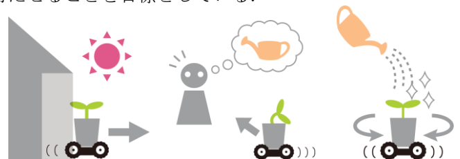
図2 PotPetの基本的な動作。(図左：日光を求めて移動、図中央：水を求めて気を引く動き、図右：水が与えられて喜ぶ動き)
