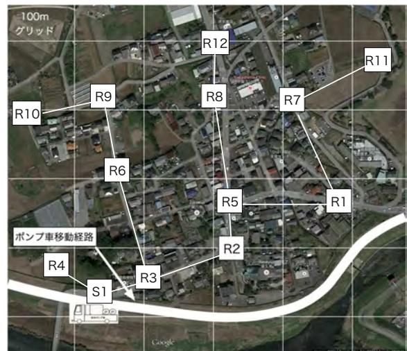
図 15 ポンプ車移動位置とネットワークポロジの変化
