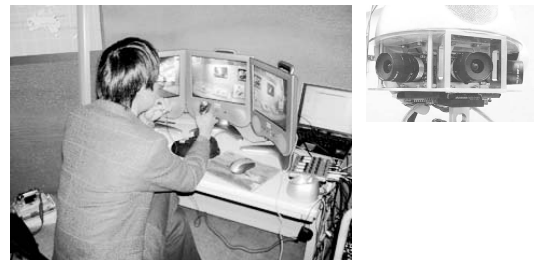
図2 頭部の3眼カメラユニット（右）と3面ディスプレイ（左） Fig.2 Three camera unit (right) and three display system (left).
