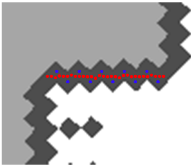
図 2 離散化による誤差の概念図
