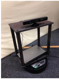
図3 見守りロボットのハードウェア構成
