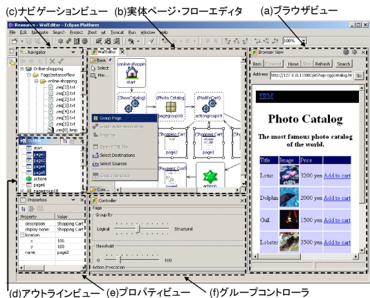
図 5 Web アプリケーションモデル抽出ツール Fig. 5 Web application model elicitation tool.
