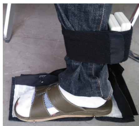
図 6 足圧布センサ装着図
