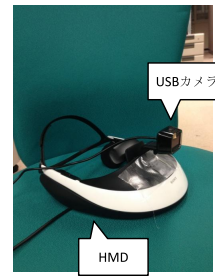
図 1 コウテイカボチャに用いる USB カメラを付加した HMD
