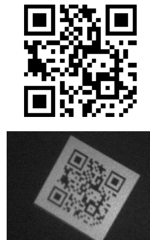
図 9 IR マーカ例 (上: 作成した QR コード, 下: 赤外線カメラを通して撮影した画像)
