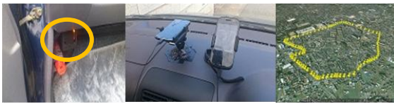
図2. ELM327装着場所(左), センシング環境(中央)及び実験走行経路(右)
