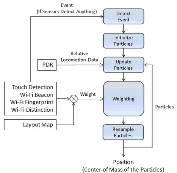
Fig. 6 Particle Filter
