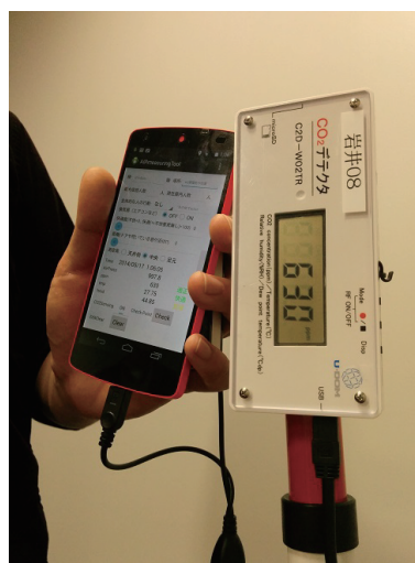
図 5 スマートフォンと CO 2 デテクタの接続図
