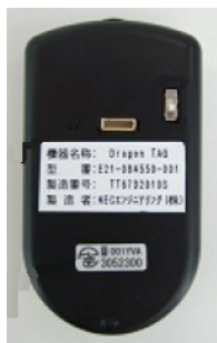
図 4 超音波センサ送信機
