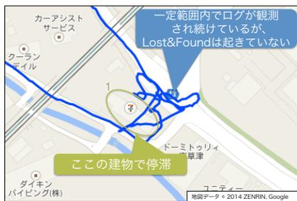
図 7 GPS ログのみを用いた判定では発見できないノイズの例
