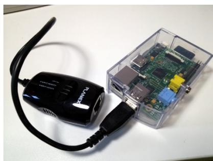
図 3 Raspberry Gate の実装例
