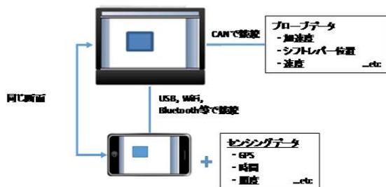
図1 想定する車載情報端末の構成
