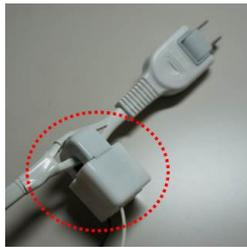
図3 延長ケーブルに設置された電流センサ.
