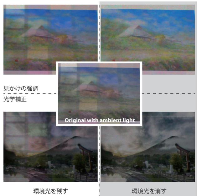
図6 本手法を用いたときの見かけ制御の結果：中央に配置した特定照明下での元画像に対して4種類の見かけとなるよう制御できる
